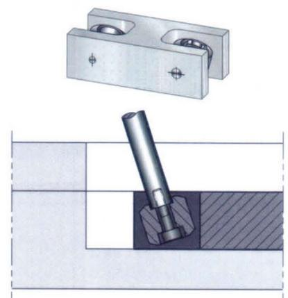
斜頂杆一端只需加工一常規螺孔，通過一個杯頭螺絲簡單固定，安裝方便，適用範圍廣。
